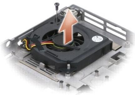
4. Приподнимите вентилятор в сборе и извлеките его из основания.
